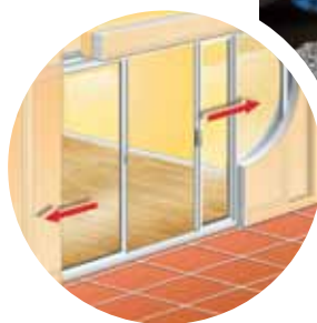
Les vantaux coulissent dans le mur de chaque côté.
